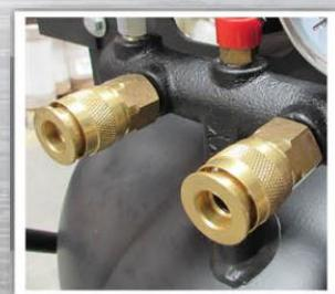
Llaves de salida quick connect, (para facilitar la conexión de manguera)
